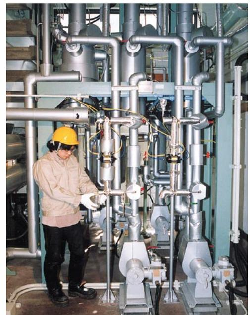
多重効用型バッチ蒸留システム
