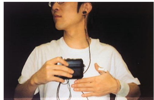
図4 小型無線化多重生理データ取得システム (センサ及びデータ送信装置)
