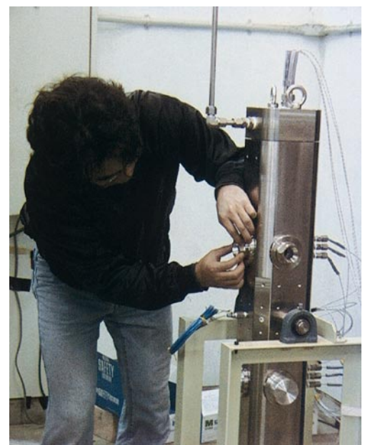
超臨界圧二酸化炭素流動ループののぞき窓を調節中
