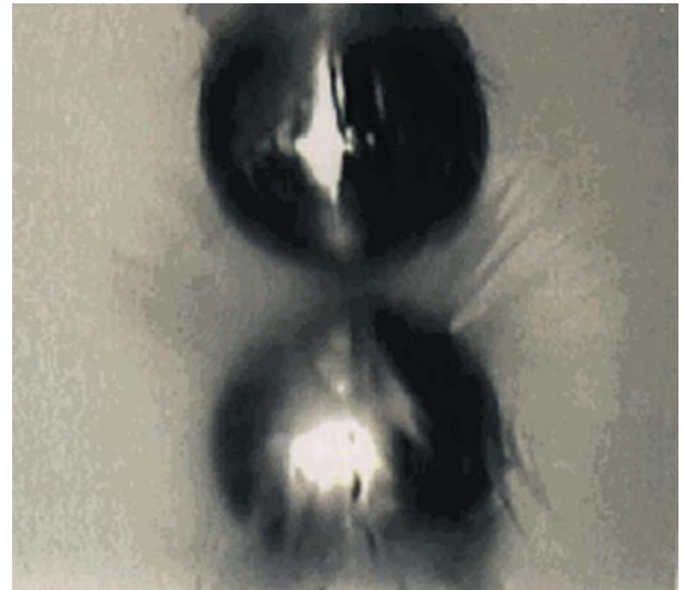
図1 電場による過冷却水の凝固制御
