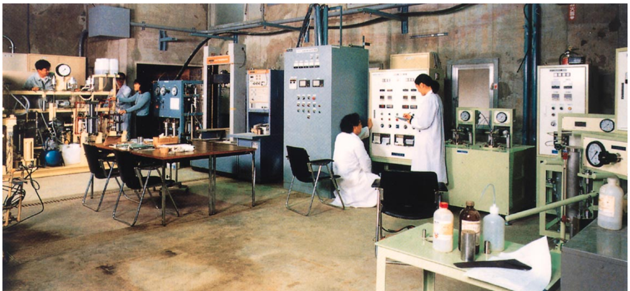
図1．実験風景（岩石強度特性評価超臨界装置、およびき裂・熱水系反応検証装置）
