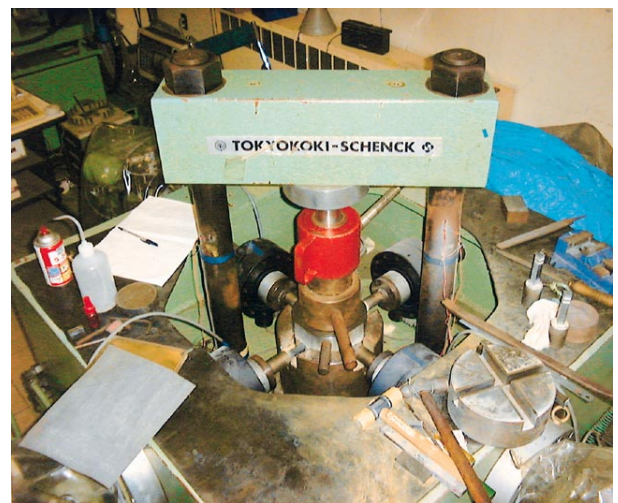
図2 せん断変形加工用試験機
