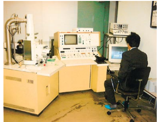
図4 結晶方位分布測定装置
