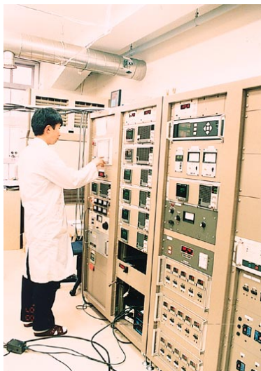
図1. 分子線エピタキシー装置の制御パネル
