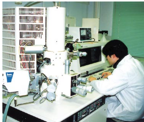
FE - SEM による複合系固体電解質の組織観察
