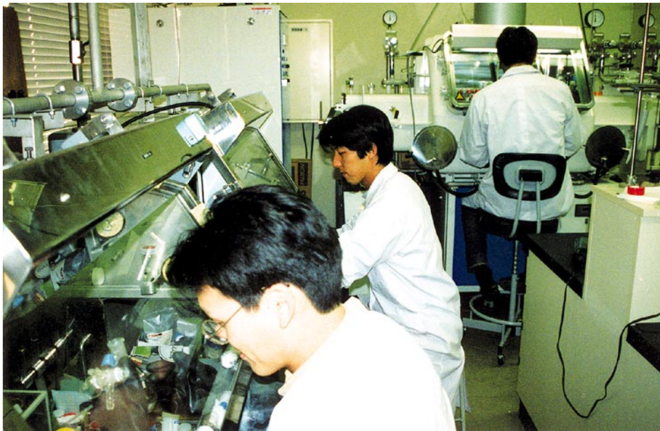
不活性ガス雰囲気での非晶質固体電解質の合成
