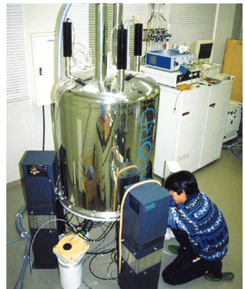
固体高分解能 NMR によるイオン伝導機構の解明
