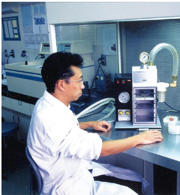
図1 遺伝子導入する装置（パーティグルガン）。
