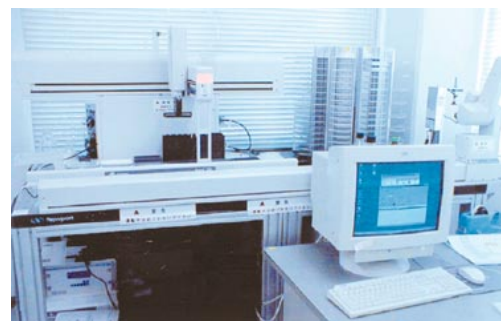
図 4. DNA アレイ作成ロボット cDNA をナイロン膜上に配列させたマクロアレイを作成するための装置。8X12cm の膜に 9,600 個の cDNA を配列させる。
