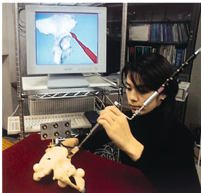
図1 三次元運動計測装置とグラフィックスコンピュータによるシステム開発。右上：三次元運動計測装置。右下：運動計測用発光ダイオードマーカ付き手術器具。
