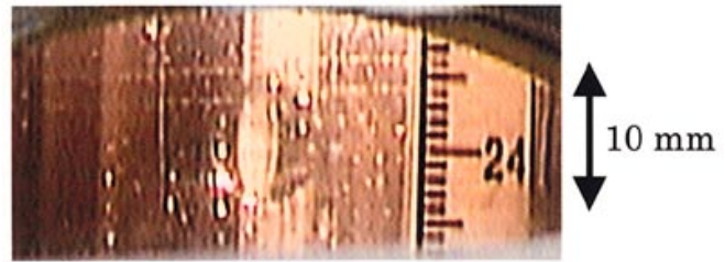
図3 水の磁気アルキメデス浮上 水の磁化率による磁気力と重力がつりあっている
