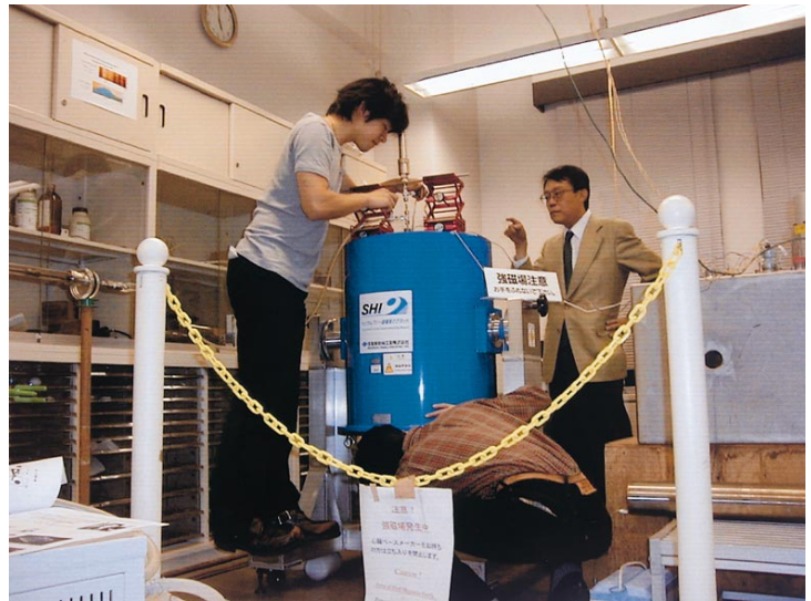
図1 10T ヘリウムレス超伝導マグネット中での結晶育成
