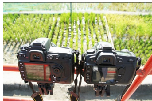
写真2 計測用4バンドカメラ
