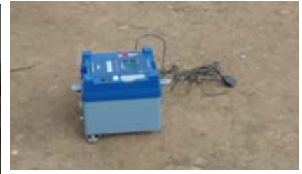
常時微動測定の測定器 McSEIS-MT NEO
