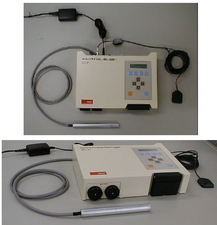
Fig.37 試作した広帯域・高感度地下弾性波計測システム
