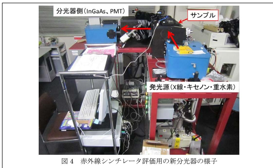
図4 赤外線シンチレータ評価用の新分光器の様子
