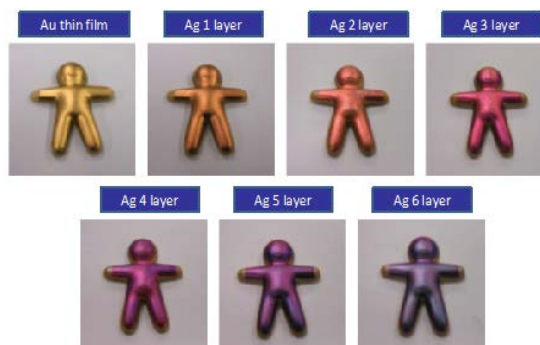
図1 金属微粒子によるフルカラーナノコーティング。曲率のある材料でも均一にコーティング可能。
