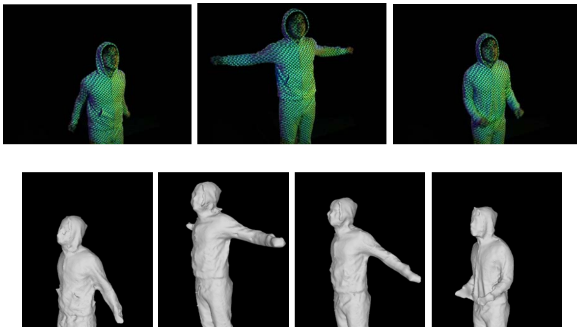
図11 (上段)計測画像例、(下段)MVSにより復元された穴のない形状例
