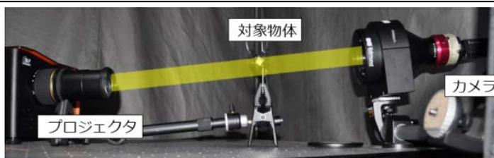
線だけを取り出す、平行高周波投影と呼ぶ計測システムを新たに構築した。これにより、空間中で交わらない透過光と、交わる散乱光を分離して計測することが可能となり、半透明物体の内部の鮮明化に成功した。また、従来の偏光板を用いた散乱光除去技術と容易に組み合わせることができ、鮮明化の効果をさらに高められることも確認した。さらに、R,G,Bの可視光だけではなく、波長が850nmの近赤外光をプロジェクタの光源とし、近赤外にも感度を持つカメラと組み合わせることで、上記(3)の評価も同時に達成した。手の指などの比較的薄い部位であれば、人体を対象とした場合にも、鮮明化が期待できることを確認した。
