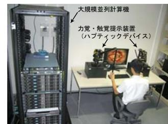
図6 大規模並列計算機と力覚・触覚提示装置からなる手術シミュレータシステム
