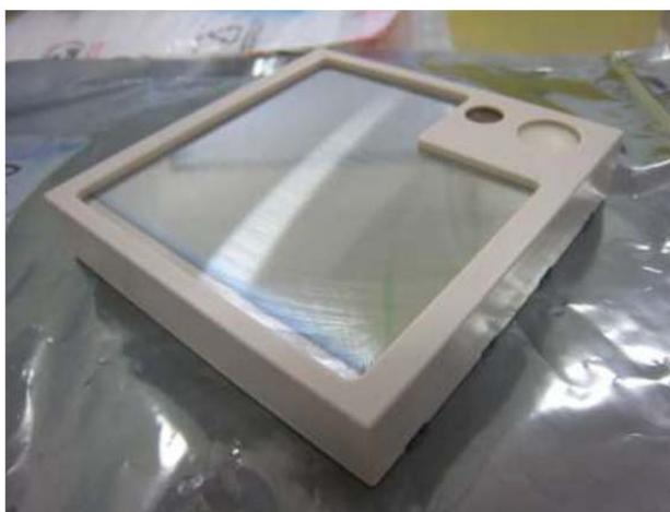
国際宇宙ステーション・「きぼう」日本実験棟に搭載予定の、CFRPを用いたサブミリ波反射鏡のサンプル(JAXA)。
