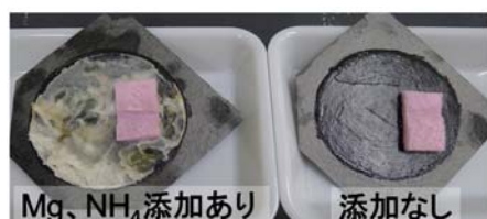
図1 廃水にNH 4 とMgを添加した場合と しなかった場合のMFCカソードの比較
