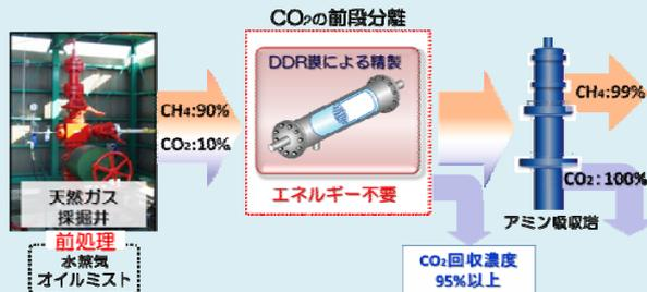
図-10 膜分離法によるCO<sub>2</sub>除去プロセスの省エネ化
