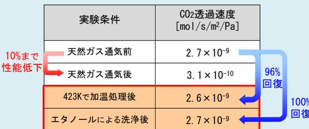
図-9 天然ガス暴露により性能低下した DDR 膜の回復試験
