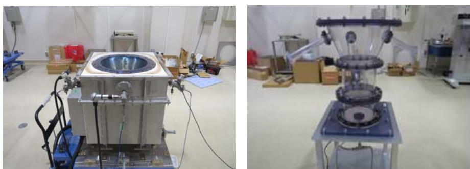
図 13 100kW 大型反応器(左)とコールドモデル(右)
