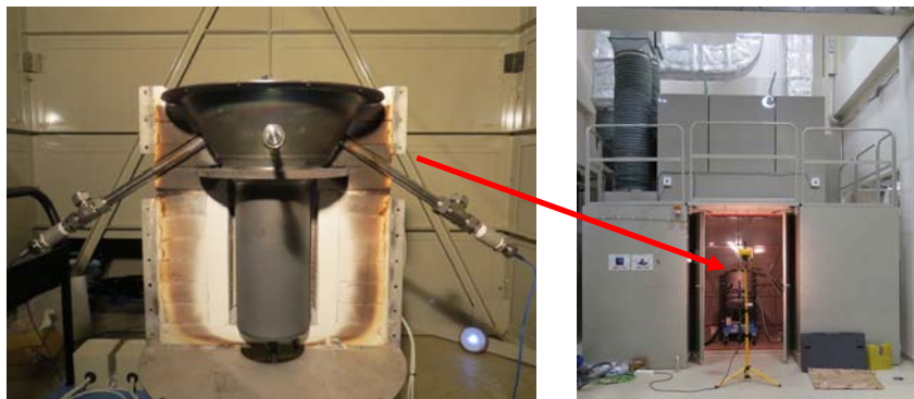
図 12 30kW 中型反応器(左)と太陽集光シミュレータによる性能試験(右)
