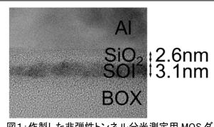
図1:作製した非弾性トンネル分光測定用 MOS ダイオードの断面透過電子顕微鏡写真
