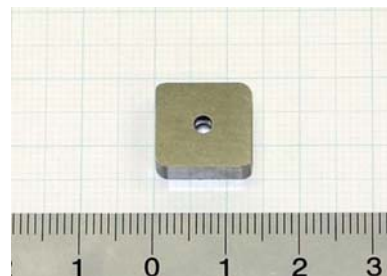
図6 研削加工, 穴あけ加工が施されたモシブチック合金チップの外観写真.
