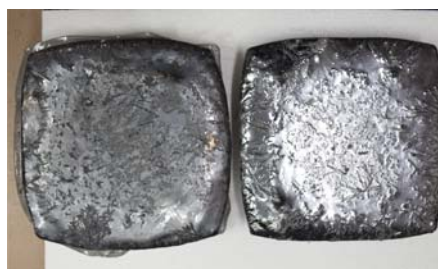
図 9 本技術により作製した 20cm 角の Si 多結晶インゴット。
