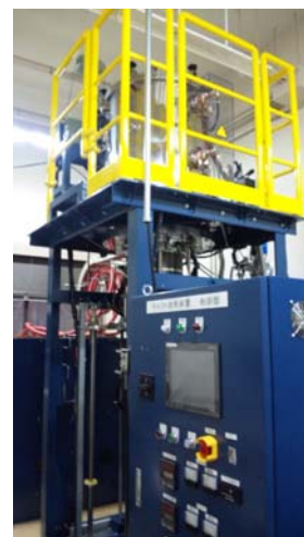
図 7 新規キャスト成長装置。
