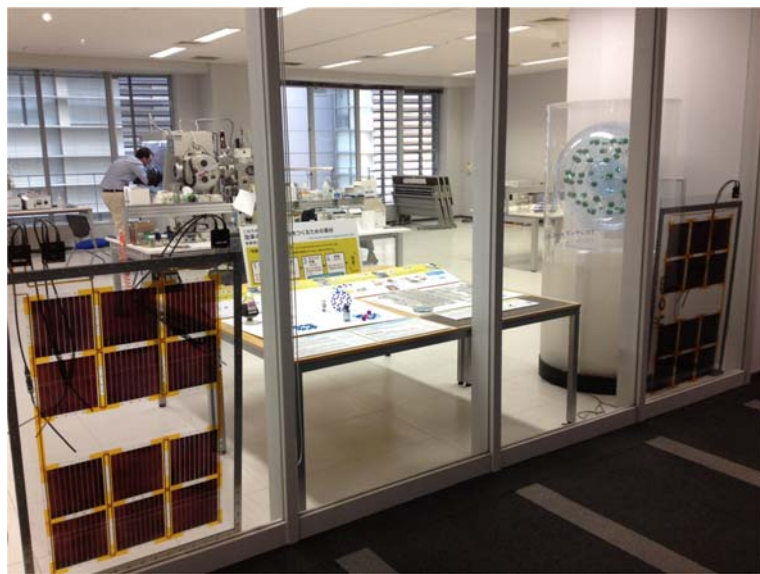
図. 日本科学未来館に設置した有機薄膜太陽電池モジュール
