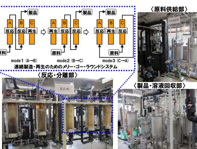
図 1 設計・製作したパイロットスケールの反応分離装置
