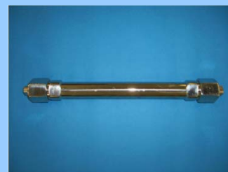
シクロデキストリン吸着剤を 充填したカラム
