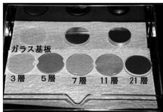
図7 実際に製作された誘電体多層膜ミラー
