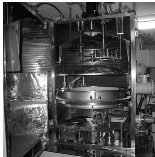
図6 新たに導入された光学薄膜用電子ビーム蒸着装置
