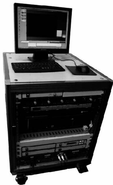
図4 自動アーカイブ収録装置 収録装置をコンパクトにまとめラックに搭載した。キャスター付きのラックで講義室から講義室へと容易に移動できるようにした。
