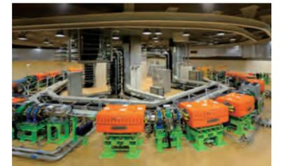
照射装置の心臓部、シンクロトロン加速器
