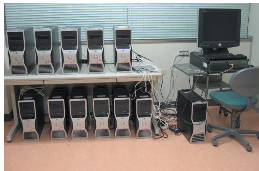
図1 モザイク画像解析システムIfA-Cluster（科研費で構築）
