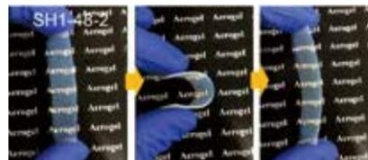
図2 (上) 常圧乾燥によって得られた、透光性、低密度、高断熱特性に優れる有機無機ハイブリッドエアロゲル
