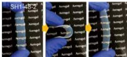
図2 (上) 常圧乾燥によって得られた、透光性、低密度、高断熱特性に優れる有機無機ハイブリッドエアロゲル (下) 大変形しても破壊せず復元する
