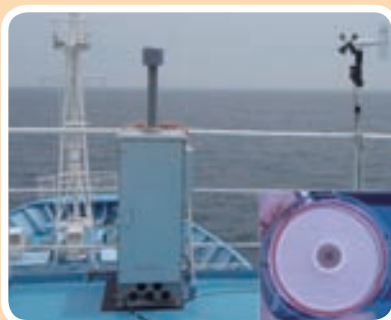
▲図1 調査船に設置したエアロゾルサンプラーとフィルター上に捕集されたエアロゾル粒子。黄砂を含む粗大粒子はフィルター中央に、微小粒子はその外側に分別捕集される。
