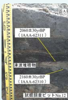
図2 津波堆積物とそれを挟む堆積層の放射性炭素年代(津波堆積物は約2000年前に堆積したことが分かる)
