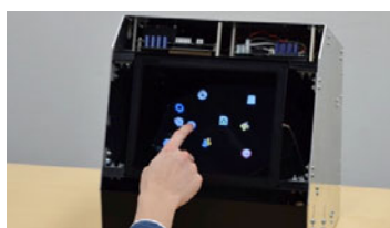
図1 触覚フィードバックのある空中タッチパネル
