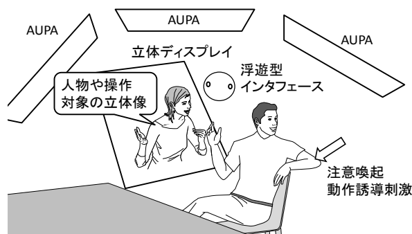
図2 空中触覚テストベンチの基本構成
