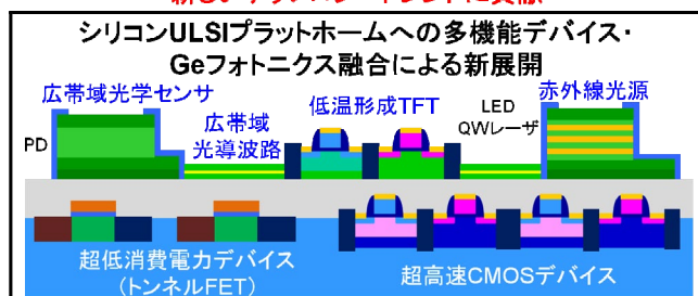
図1 Sn 系 IV 族半導体技術が貢献する多機能・省電力デバイスの概念図。
