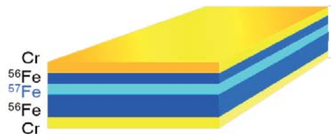
図2. Fe層をメスバウアー効果に感度のある 57 Feで同位体置換を行ったFe-Cr多層膜
