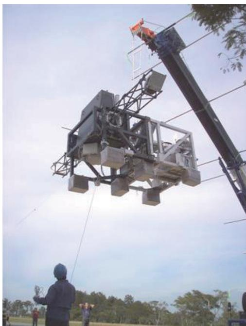
図1 科学観測用大気球に搭載する宇宙遠赤外線干渉計 FITE の打上げ前試験の様子 (ブラジルの気球基地に於いて)
