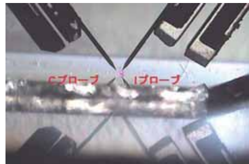
図2：試作された近接場2プローブ分光装置
