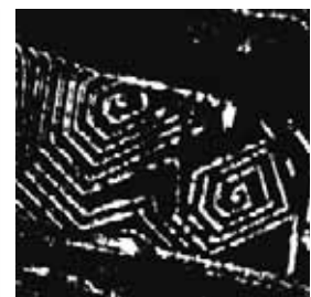
金雲母 (phlogopite) の結晶表面 I. Sunagawa - P. Bennema (1982)
