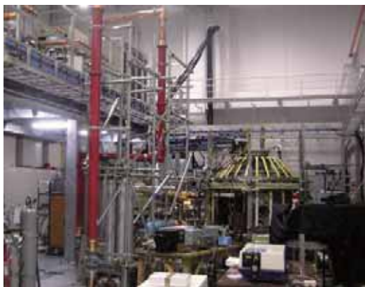
TST-2 球状トカマクと LHW 入射装置（左側）
