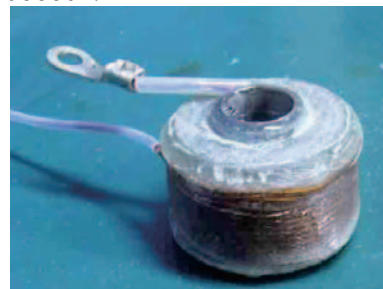
図1 直径3 cmの小型コイル
