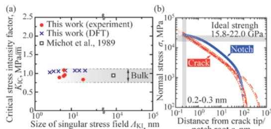
図3 実験による single digit ナノひずみ場からの破壊基準の検討結果
