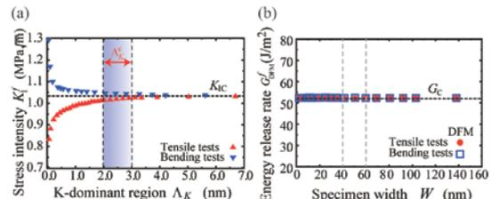
図4 原子シミュレーションを用いた single digit ナノひずみ場からの破壊支配力学量の検討結果
