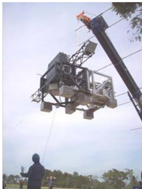
遠赤外線干渉計（科学観測用大気球搭載型）の打上前試験の様子
