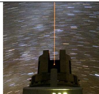
図 2：すばる望遠鏡からレーザーを照射して上空に人工星をつくる。
