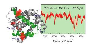
る。ミオグロビン(Mb)という筋肉の赤色を与える蛋白質の一酸化炭素(CO)錯体の、CO を光解離させた後の振動スペクトルを、時間を刻んで測定する実験を計画した。
