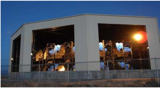
望遠鏡アレイ(TA)実験は、米国ユタ州の砂漠地帯に、地表粒子検出器(前頁右図)を、1.2km間隔で507台設置し、ほぼ700km<sup>2</sup>の領域をカバーする。また38台の望遠鏡を3ヶ所にまとめて配置し、地表アレイ上空を監視している(上図)。地表アレイと望遠鏡を同じ場所に置いて同時観測を行い、まれな極高エネルギー宇宙線から、可能な限り多くの情報を集めて、正しい測定を行うことを目指している。
