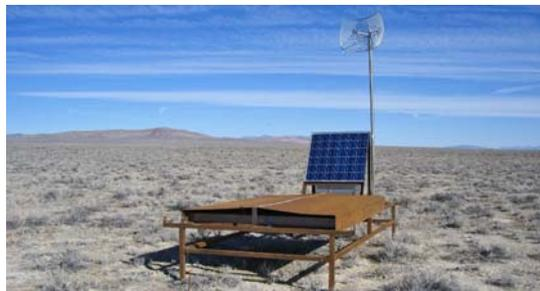
宇宙線の方向は検出器間の粒子到来時間差から決める。広い領域を 24 時間・365 日安定して観測できる点が強みだが、粒子の総数から宇宙線のエネルギーを決める時に、詳細が良く判っていない大量の計算をしなければならない。
