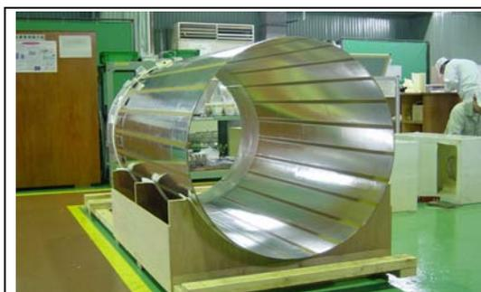
荷電粒子を振り分ける超伝導磁石
