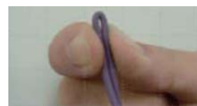
曲げ、結び、束ねなど実用上の自由度が大きいプラスチック光ファイバー
